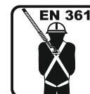
Utilizzare solo imbracature di sicurezza conformi alla norma EN 361
