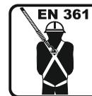
utiliser uniquement des harnais de sécurité conformes à la norme EN 361
