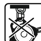
das Gerät nicht an einem Punkt einer festen baulichen Einrichtung (Anschlagpunkt) mithilfe des Geräteragegriffs befestigen
