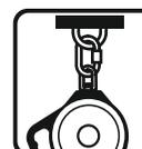
Collegare il dispositivo a un punto della struttura fissa (punto di ancoraggio) utilizzando un aggancio rotante
