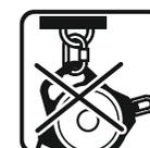
non fissare il dispositivo al punto della struttura fissa (punto di ancoraggio) mediante la maniglia destinata al trasporto del dispositivo
