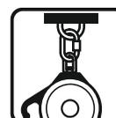
das Gerät mit dem Drehgriff an einer festen baulichen Einrichtung (Anschlagpunkt) befestigen
