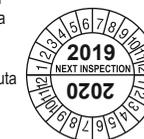
Mese e anno dell'ispezione in fabbrica successiva. Non utilizzare il dispositivo dopo questa data. Attenzione: Prima del primo utilizzo contrassegnare la data dell'ispezione condotta in fabbrica (data del primo utilizzo +12 mesi, ad es. primo utilizzo 01.2019 - contrassegnare l'ispezione al 01.2020)
