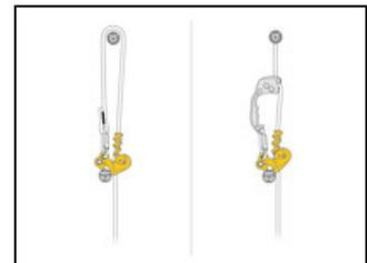
Der mechanische Prusik ZIGZAG ist für die Verwendung am Doppelstrang bestimmt und kann mit dem Zubehör CHICANE, das die Bremsreibung beim Abseilen erhöht, und den Kniesteigklemmen-Systemen KNEE ASCENT, die den Aufstieg erleichtern, auch am Einfachstrang verwendet werden.
