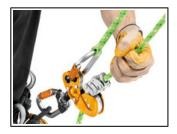
Der Entriegelungshebel ermöglicht eine gleichmäßige und präzise Seilausgabe und eine hohe Präzision bei der Fortbewegung. Der Anwender kann die Abseilgeschwindigkeit steuern, indem er den Druck auf den Hebel verändert.
