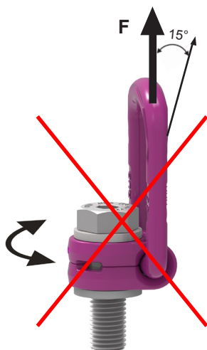
Image 3 : mouvement de rotation interdit en chargement dans la direction de l'axe de la vis
