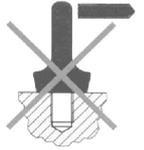
9. Der STARPOINT muss im festgeschraubten Zustand und ausgerastetem Sternprofilschlüssel um  $360^\circ$  drehbar sein. Vor Einhängen des Anschlagmittels in Krafrichtung einstellen.
