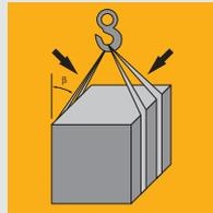
■ Tenere conto della modalità di imbragatura e dell'angolo di inclinazione.
