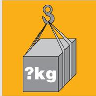
■ Controllare il peso del carico. Non sovraccaricare i tiranti.
